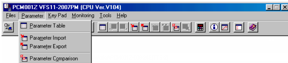
Figure 3-14 Parameter menu screen (Parameter table non display)
